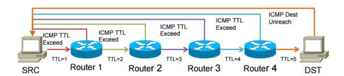
Клиент посылает ICMP-сообщение на узел назначения точно так же, как и при **ping**, но ему задается TTL=1. Первый маршрутизатор, получив сообщение, отбрасывает его и в ответ генерирует ICMP-сообщение об ошибке (TTL истекло) с указанием собственного IP-адреса в качестве адреса отправителя (его мы и видим в выдаче).
